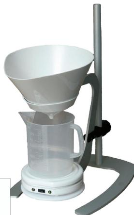
**COD. NFLW4/C Flussometro connesso via cavo, completo di trasduttore di flusso, modello 2009, amplificatore, stativo smontabile, e beaker da 2 litri.**
